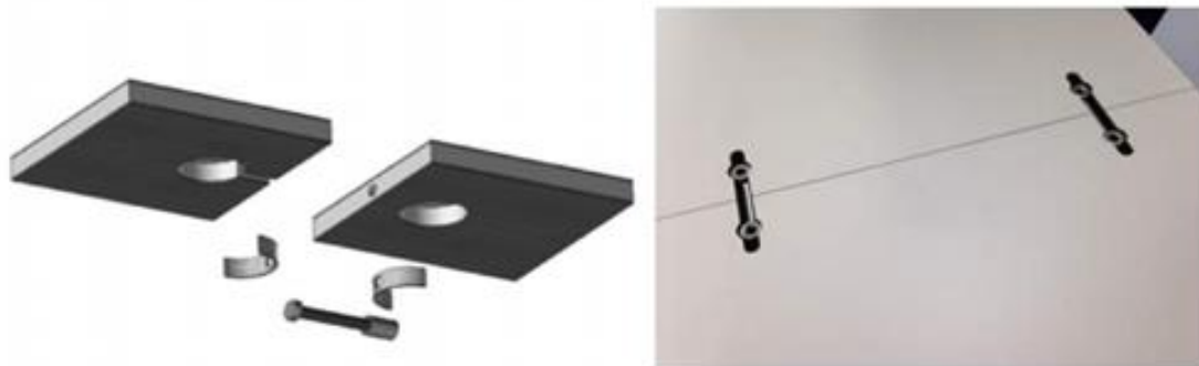
Połączenie za pomocą łącznika
