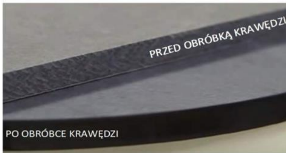
krawędzie przed i po polerowaniu
